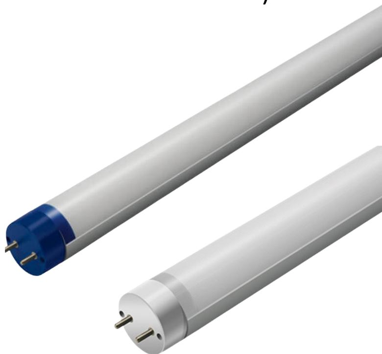
Die einfachste Lösung, sofort Energie einzusparen. 150 cm lange Leuchtstoffröhren mit 58 Watt verbrauchen inklusive dem Vorschaltgerät bis zu 71 Watt. Die LED-Röhre einfach gegen die alte Leuchtstoffröhre austauschen. Einen vorhandenen Starter ggfls. durch den LED-Dummy Starter ersetzen. **Fertig!** Dadurch ergibt sich eine Energieeinsparung von bis zu 66 Prozent.
